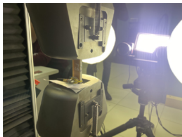
Рис. 3. Образец стеклопластика в процессе испытания на растяжение
