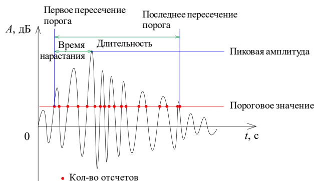
Рис. 5. Графическое представление формы сигнала акустической эмиссии
