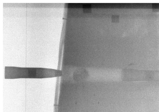
Рис. 3. Кинорентгенограмма входа и движения МО в преграде
