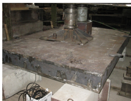
Рис. 8. Натурная плита размером в плане 2000×3000 мм перед испытанием
