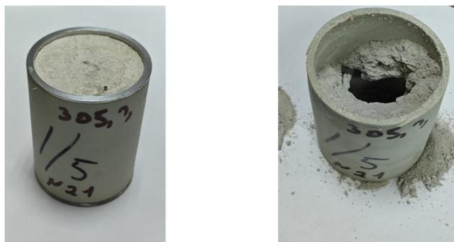
Рис. 2. Контейнер с мелкозернистым бетоном до и после эксперимента
