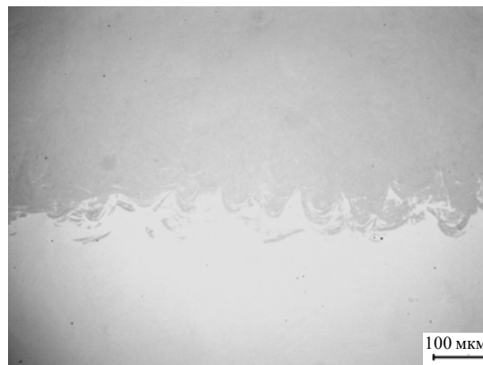
Рис. 4. Изображение области соединения материалов в ПЛС-образце биметалла Ti6Al4V–Ti
