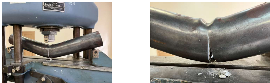
Рис. 4. Разрушение ТББ по нормальному сечению
