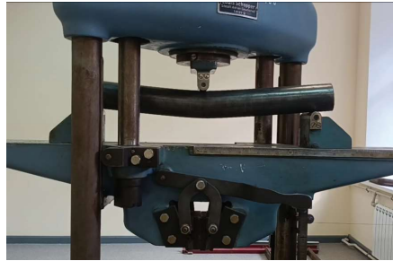
Рис. 6. Внешний вид образца при линейном деформировании
