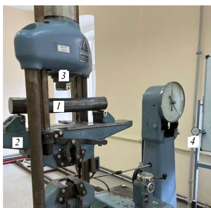
Рис. 2. Экспериментальная установка для испытаний ТБК на трехточечный изгиб
