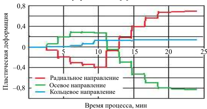
Рис. 5. Изменение пластической деформации в процессе раскатки
